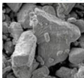
Particules stratifiées à la géométrie agressive (x1000)
