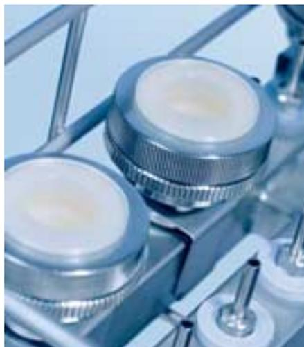
Panier supérieur à injection O 177/1 pour instruments à cavité
