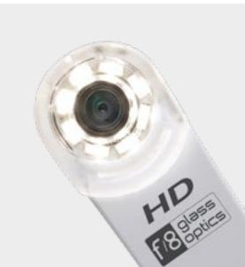
**Caméra HD.** La caméra C-U2 possède une optique en verre et diffuseur LED, elle intègre un capteur HD 16 : 9 pouvant prendre des images cliniques à haute définition.
