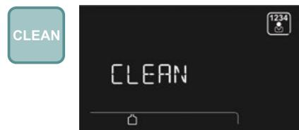
**Clean.** Fonction qui inhibe le fonctionnement du clavier pendant le nettoyage de la surface en verre de la console, évitant l'activation involontaire des commandes.
