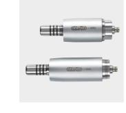
Micromoteurs. Deux versions: i-MMr (3,3 Ncm) avec et sans LED; i-MMs (5,3 Ncm) avec éclairage LED, prédisposition pour des traitements endodontiques. Toutes les deux de 100 à 40 000 tours/min.
