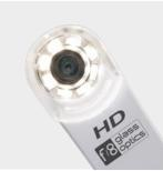
Caméra HD. La caméra C-U2 possède une optique en verre et diffuseur LED, elle intègre un capteur HD 16:9 pouvant prendre des images cliniques à haute définition.
